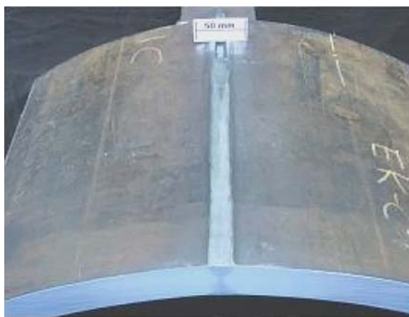
рисунки 1. Лазерно-дуговая сварка трубных секций
